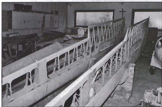
Die Flügel sind nun ohne Bespannung.
