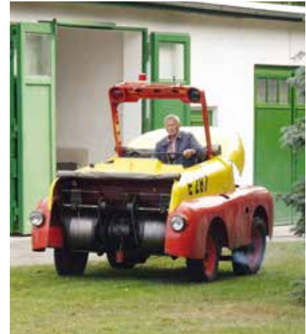
Die historische Herkules III-Winde auf dem Weg zu ihrem Einsatz auf einem historischen Flugplatz. Für den Schlepp von Oldtimern ist sie – wofür sie schließlich gebaut wurde – hervorragende geeignet. The mighty Hercules III lurches out onto the field! This historic winch from DDR times, at an equally historic airfield, proved to be excellent for launching Oldtimers (just as she was designed to do!).
