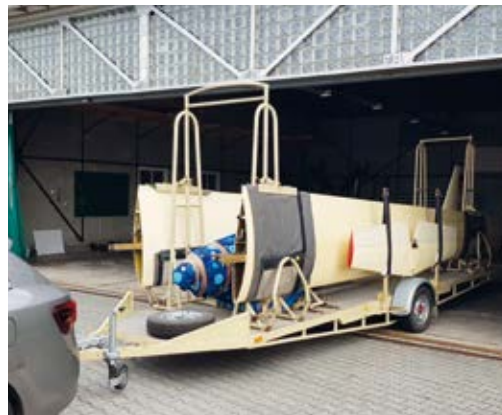
Transport des Favorit von Jahnsdorf nach Finsterwalde auf einen Anhänger STW Typ 2. Diese Anhänger wurden in der DDR gebaut und "Transatlantik" oder "Transall" genannt. Die Serienproduktion begann 1957 beim VEB MAB Schkeuditz und endete 1959. Es sind mindestens 72, eventuell auch 89 Exemplare gebaut worden – sowohl in offener Ausführung als auch wetterfest mit Spriegel und Plane.
